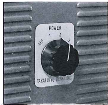
送風器の風量切換器は、電源スイッチと一体になっており、弱・中・強の3段になっています。
